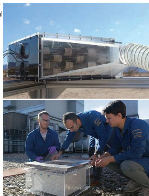
*Omar Yaghi et ses collègues préparent leur dispositif pour capter l'humidité de l'air. Il contient un composé poreux qui piège l'eau durant la nuit puis libère le liquide dans la cuve fermée durant la journée, quand la température monte.*
