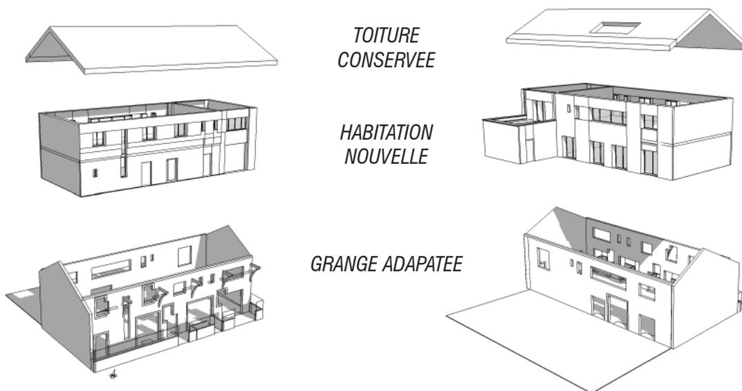
*Concept partie conservée et partie nouvelle: percement des façades Nord et Sud de la Grange suivant fonctionnalité intérieure*
